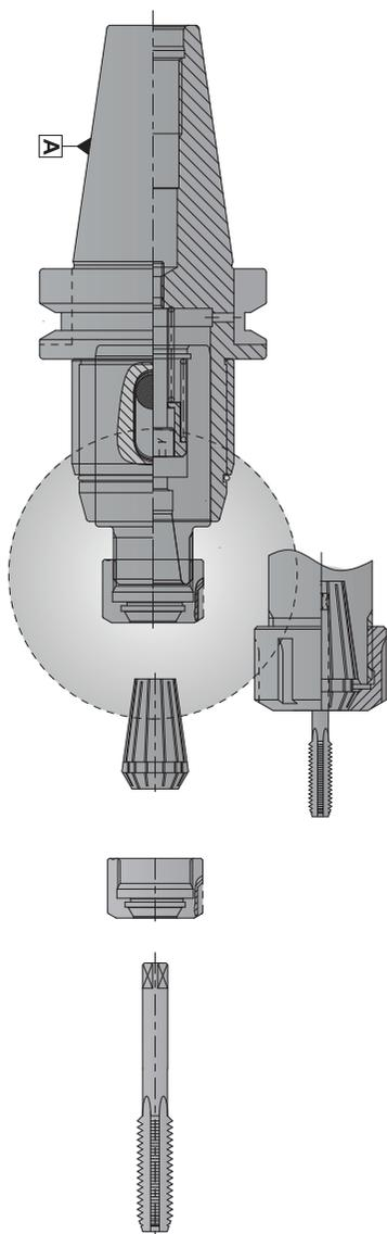
Минимизация воздействия на инструмент при обработке короткой колеи
